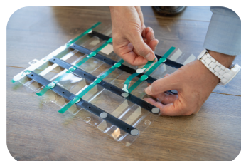
Tirer sur les bandes vertes pour retirer les protections des abrasifs.
